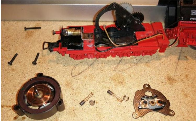
Nach Lösen der drei Schrauben kann das Motorschild entfernt werden.
